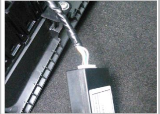
2.24 所有线束接好后把解码器放在驾驶室 A 柱位置并用魔术贴或电工胶布固定好；
