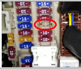
2.20 接正极：将保险丝取电器脚码芯片插入保险盒脚码芯片凹槽内；注意：如图对应位置正极插入，若反插将导致车门无法使用
