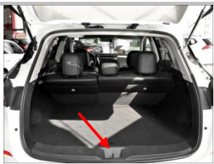
4.1 拆下后踏盖侧面的塑料卡扣，双手把后踏盖从底处掰开；
