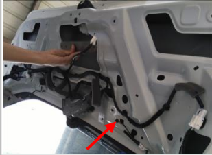
2.22 接负极：在车尾门上，箭头位置找到原车螺栓柱；
