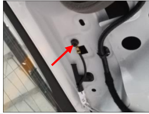
2.23 接负极：松动螺母，卡进负极连接片，卡紧后再还原拧紧螺母，
