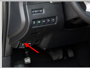
2.25 接 OBD 在驾驶室中控台底下找到 OBD 接口；
