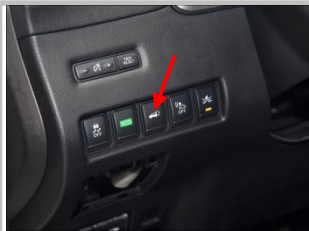
2.28 安装楼兰中控开关：中控开关按钮安装在此处位置；
