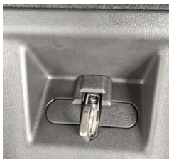
4.8 还原安装原车后踏盖，最后装上我司小盖板（ 须匹配原车后踏盖颜色 ）；
