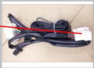
2.27 接 OBD 拆下原车 OBD 插头，用我们的接头还原安装，露出来的线隐藏好。
