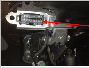
2.26 接 OBD 拆下原车 OBD 插头，用我们的接头还原安装，露出来的线隐藏好；
